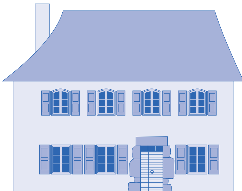
La disposition et les proportions des ouvertures donnent du caractère à la façade.
